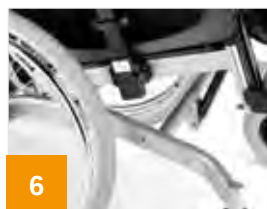
6 Longueur de châssis réglable en fonction de la profondeur d'assise
